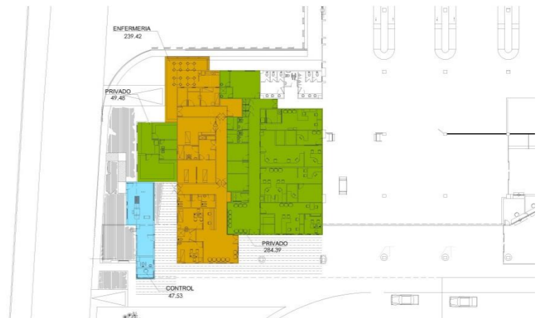
Ilustración 29 Planta primera – Zonas Técnicas en la parte norte del Edificio
