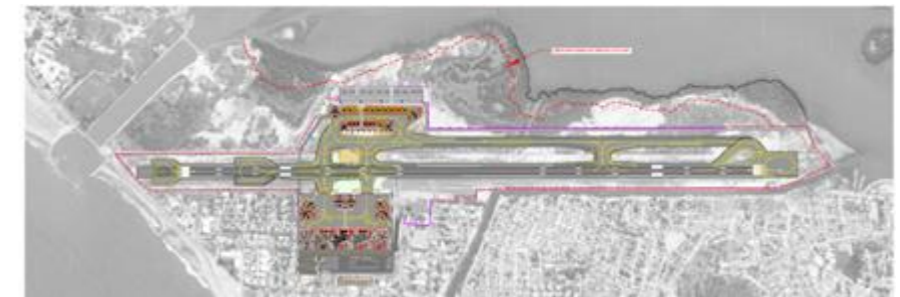
Ilustración 3 Configuración Campo de Vuelo con prolongación rodadura paralela.
