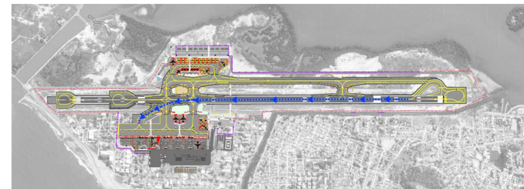
Ilustración 17 Rodadura de aterrizaje en Horizonte III. Calle de salida rápida
